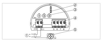
Отсек электроники и подключения (однокамерный корпус)
